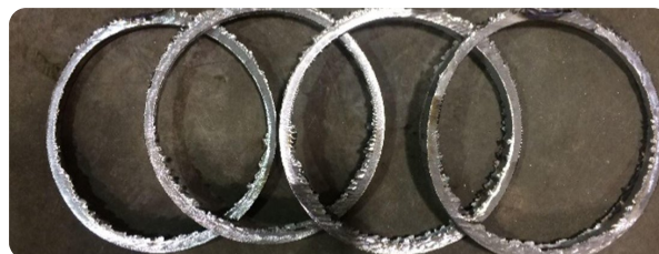
Casquillos de tubos de acero seccionados con hilo CBM.
